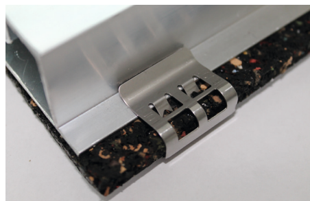
Opción de instalación 2 - perfil centrado en la estera: Deslice el clip en la estera sobresaliente hasta el final, fijando la pestaña del clip en el perfil.
