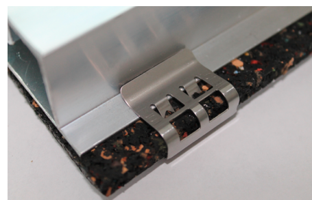
Opción de instalación 2 - perfil centrado en la estera: Deslice el clip en la estera sobresaliente hasta el final, fijando la pestaña del clip en el perfil.
