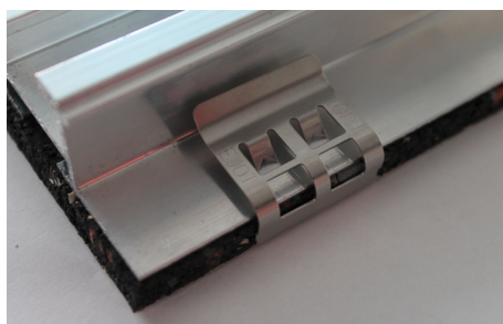
Opción de instalación 1 - perfil a ras de la estera: Deslice el clip en la estera y el perfil hasta el final.
