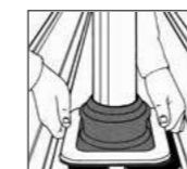
2. Ajustar DEKTITE® a la chapa perfilada y marcar.
