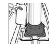
4. Fijar DEKTITE® con tornillos autotaladrantes EJOT® o remaches Bulbrite.
