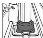
5. Fijar DEKTITE® con tornillos autotaladrantes EJOT® o remaches Bulbrite.
