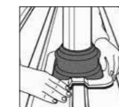
3. Ajustar DEKTITE® a la forma de la chapa perfilada.
