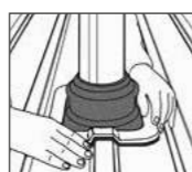
4. Ajustar DEKTITE® a la forma de la chapa perfilada.
